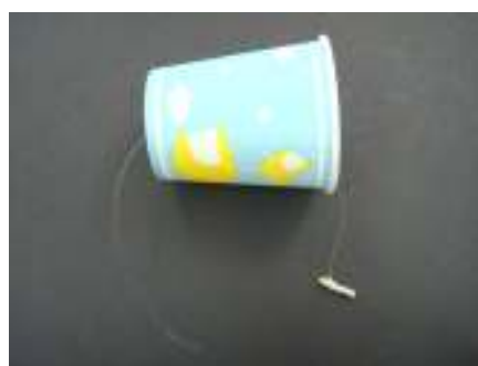
圖 7 將釣魚線由紙杯底之小孔穿入， 並在其末端綁一小段牙籤
