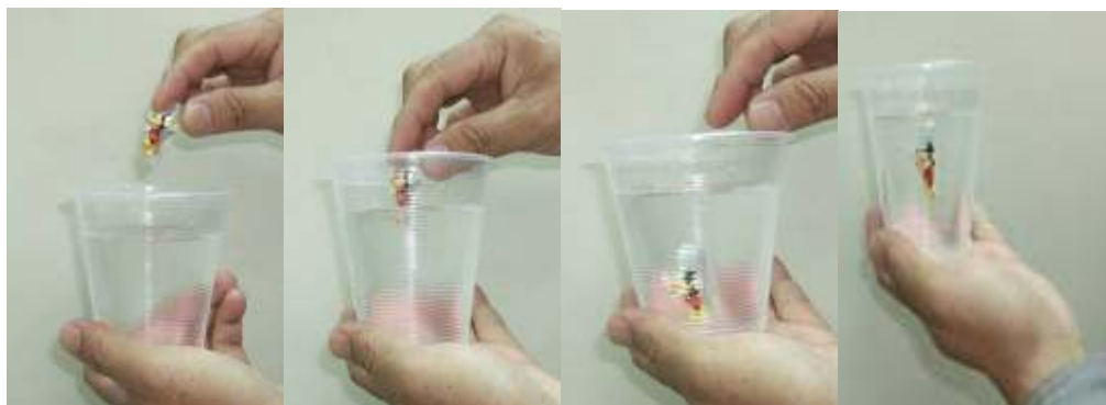
圖 2 測試浮體吸水後之比重
